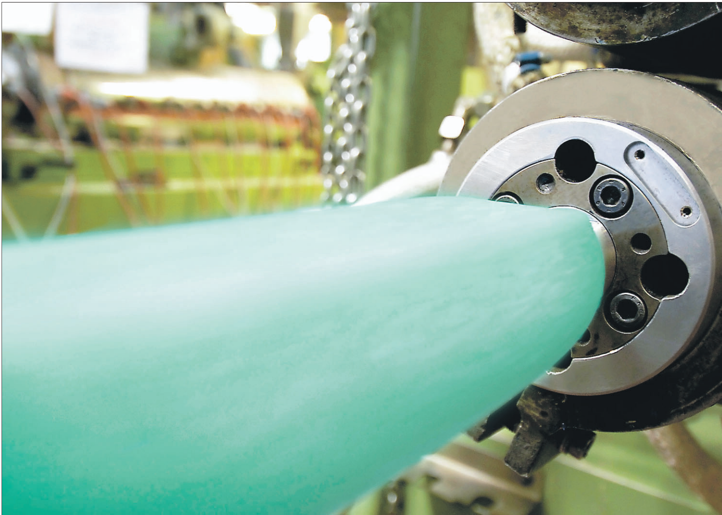
Blick auf die Produktion des in jeder Hinsicht grünen NMC-Schaums Nomapack Green.
